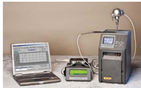
计量炉 917X, 数字温度计 1529, PRT 以及软件构成的现场温度计量系统
