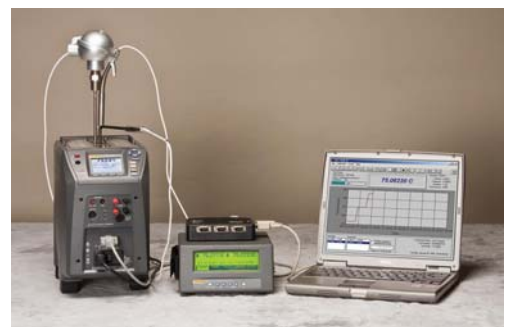
计量炉 914X, 数字温度计 1529, PRT 以及软件构成的现场温度计量系统
