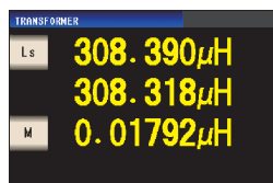
变压器测量模式 漏感测量界面
