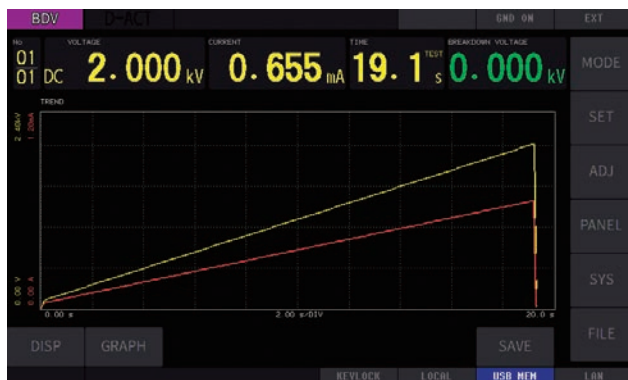
连续升压测试示例
