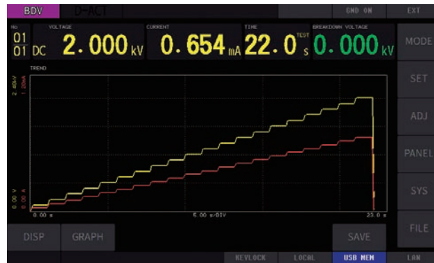
逐级升压测试示例
