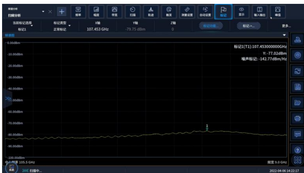
101GHz ~ 110GHz 频段显示平均噪声电平测量结果
