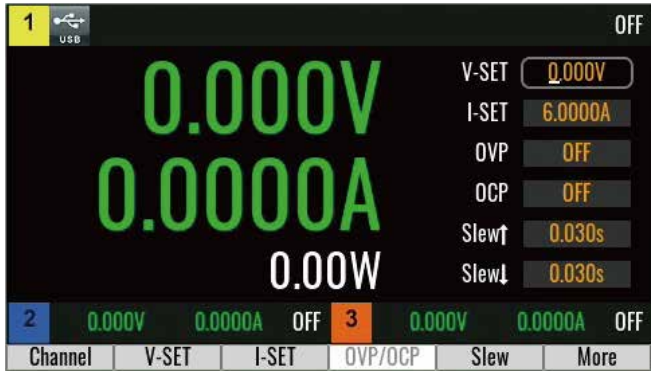
单个通道的Meter界面以及快速设置界面
